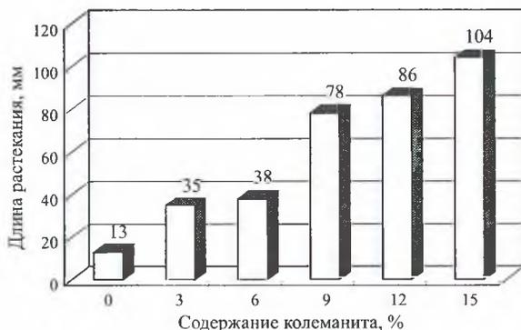
Рис. 5. Зависимость длины растекания глазури от содержания колеманита в шихте (сверх 100 %)
