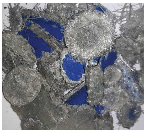
а – неизмельченные отходы стеклопластика; б – влияние частоты вращения ротора на количество неизмельченного материала
