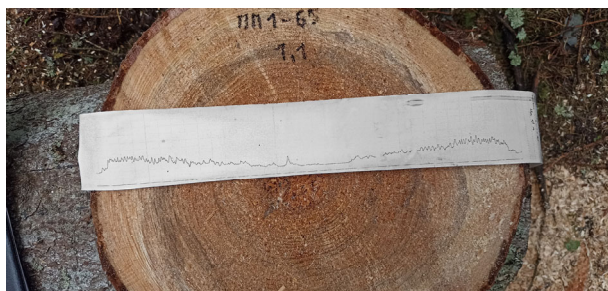
Рис. 10. Резистогамма гнили на III стадии гниения
