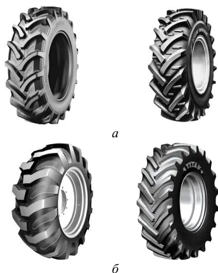
Рис. 5. Примеры протекторов пневматических шин «елка»:
