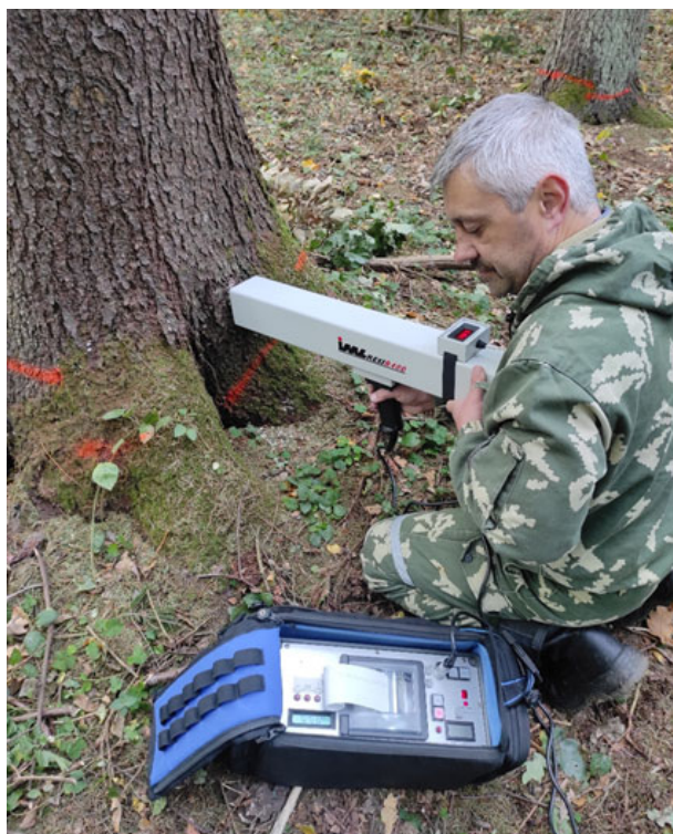
Рис. 9. Обследование дерева при помощи резистографа
