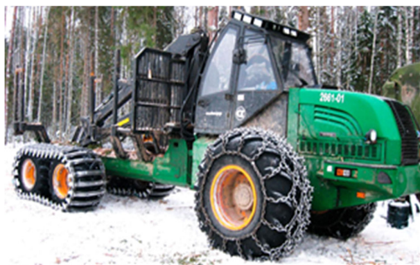
Рис. 6. Форвардер, оборудованный гусеницами и грунтозацепами
