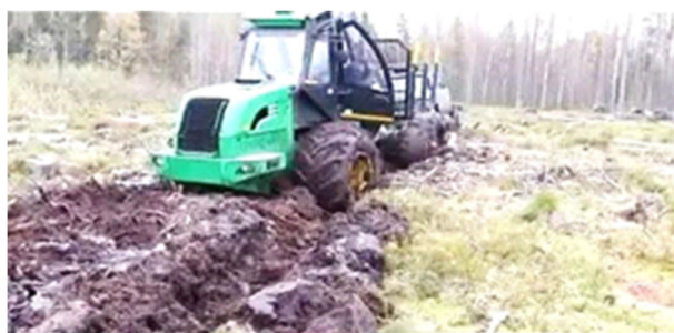
Рис. 1. Процесс образования колеи после проезда форвардера
