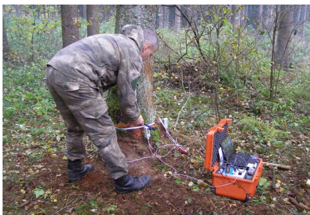
Рис. 11. Обследование дерева при помощи импульсного томографа
