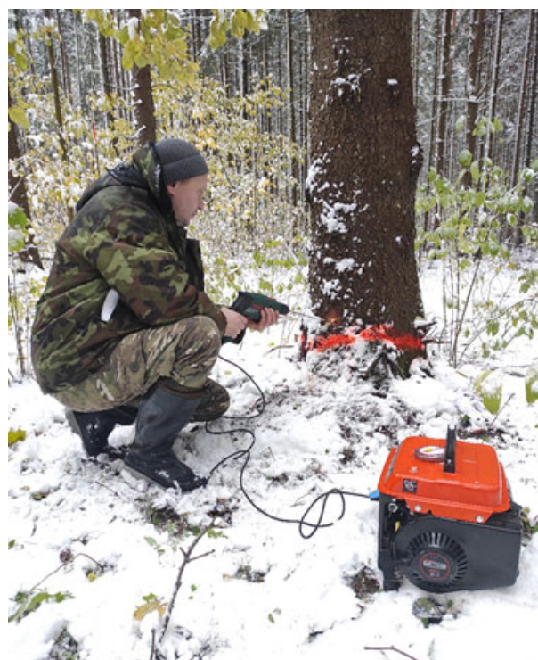
Рис. 5. Применение электрической дрели для диагностики гнили
