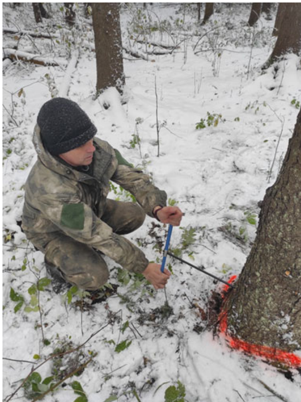
Рис. 7. Обследование дерева при помощи возрастного бурава
