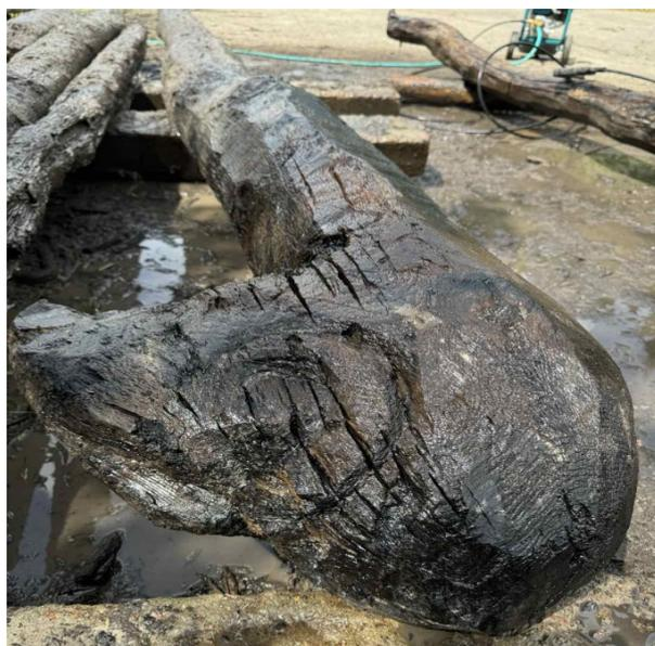
Рис. 7. Гаковая часть конструкции после гидромеханической очистки
