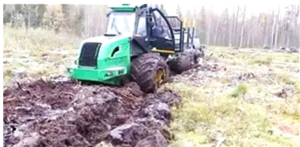
Рис. 1. Процесс образования колеи после проезда форвардера
