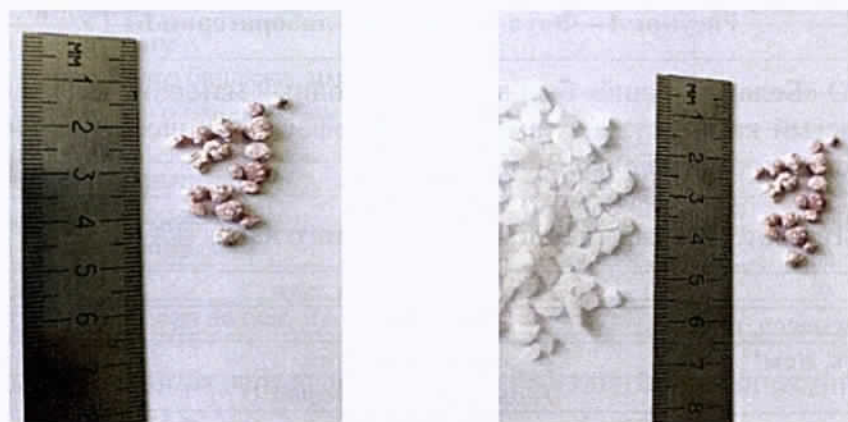
Рисунок 2 – Гранулы, полученные в результате гранулирования комплексных удобрений в лабораторных условиях
