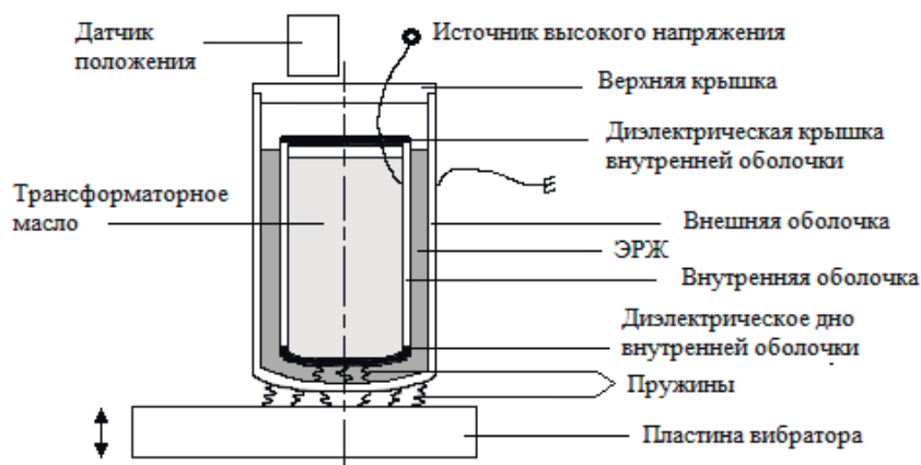
Рис. 1. Схема и фотография макета оболочкового элемента
