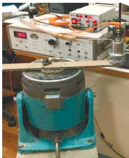
Рис. 2. Вибростенд для исследования колебаний макета различных объектов
