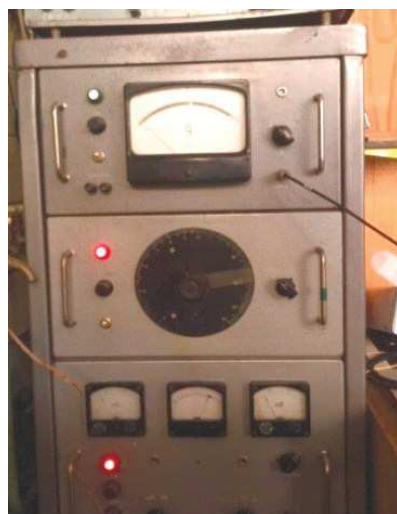
Рис. 2. Вибростенд для исследования колебаний макета различных объектов
