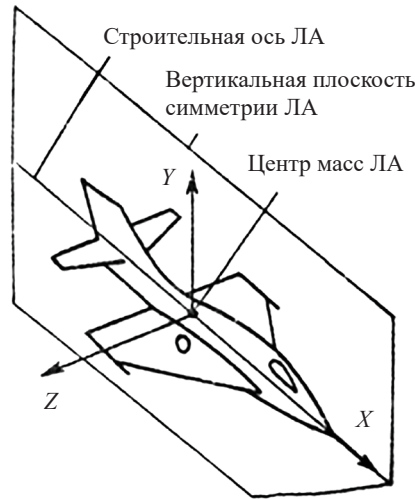
Рис. 2. Положение системы координат бортовой радиолокационной станции относительно летательного аппарата [10]
