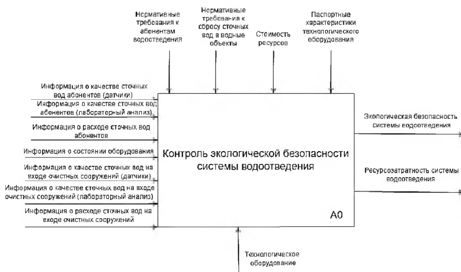
Рис. 3. Контекстная диаграмма контроля экологической безопасности водоотведения
