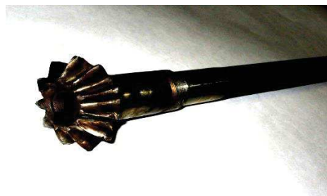
Рисунок 2 – Конические колеса после наработки 2700 моточасов
