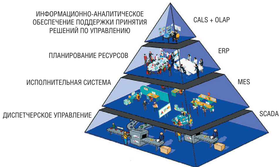
Рис. 1. Иерархическая архитектура построения информационно-управляющих систем промышленно-коммунальными объектами:
