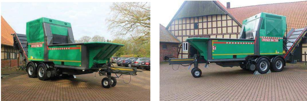
Рисунок 1 – Общие виды молотковой дробилки JENZ BA 725 D
