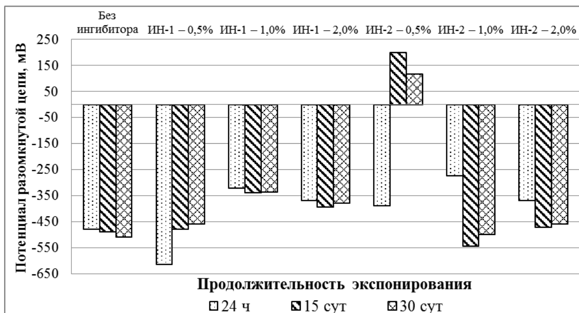
Рисунок 1 – Влияние ингибиторов коррозии на потенциал разомкнутой цепи ( V_{рц} , мВ) эпоксидных покрытий
