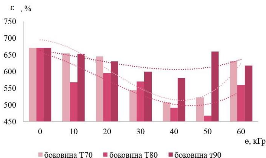
Рисунок 2 – Зависимости условной прочности при растяжении резины беговой части протектора грузовой шины от величины дозы радиационной обработки и режима термохимической вулканизации
