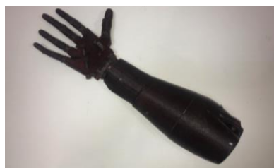
Рисунок 7 – Распечатанная на 3D принтере роботизированная рука
