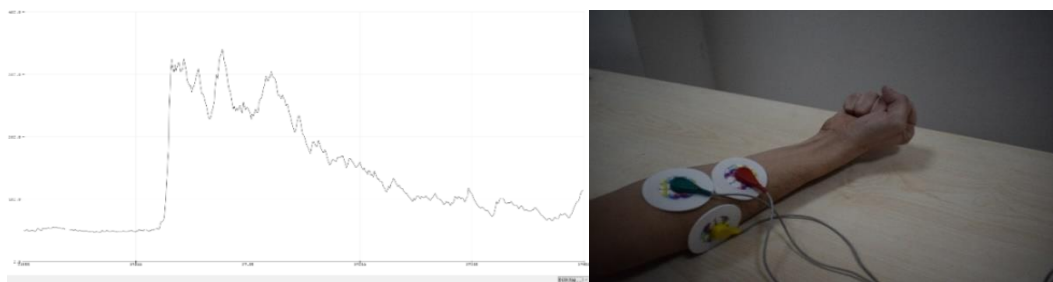
Рисунок 2 – Результаты электромиографического датчика (напряжённое состояние мышц)
