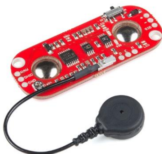
Рисунок 1 – MyoWare Muscle Sensor (AT-04-001) электромиографический датчик
