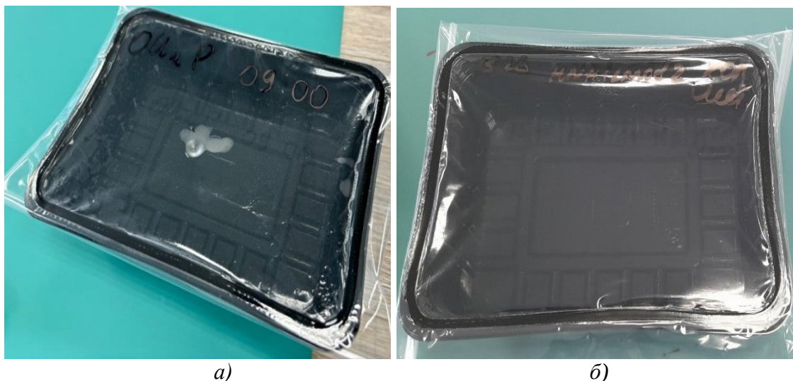
Рисунок 1 – Определение устойчивости к запотеванию: а) 5 баллов – 1 тип через 6 ч экспозиции; б) 9 баллов – 2 тип
