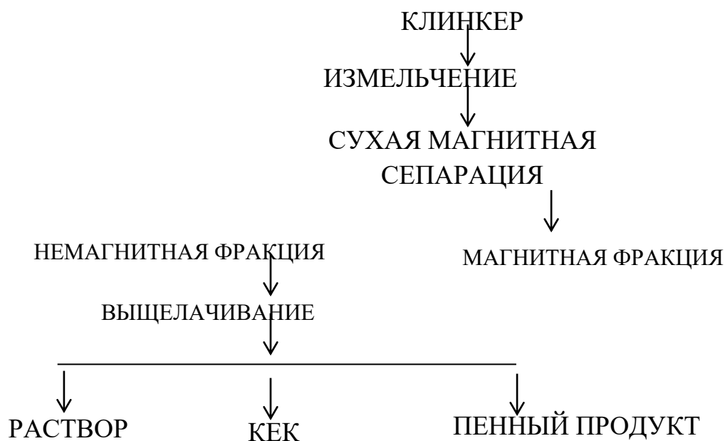
Рисунок 1 – Схема извлечения редких металлов из клинкера
