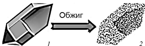
Рисунок 1 – Схема темплатного синтеза: 1 – исходный MOF; 2 – пористый оксид [1].
