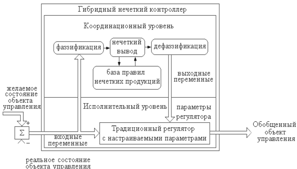
Рисунок 2 – Архитектура гибридной нечеткой САУ
