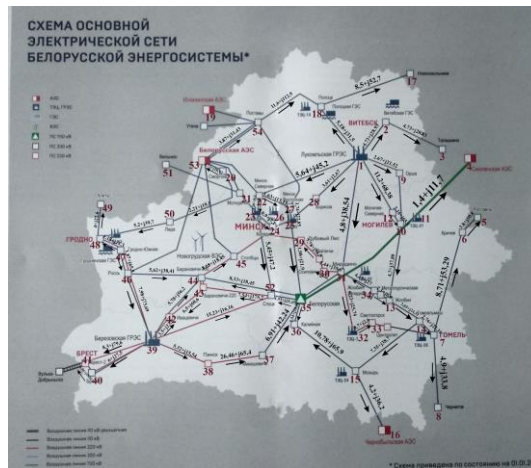
Рисунок 2 – Схема высоковольтной электрической сети Белорусской энергосистемы
