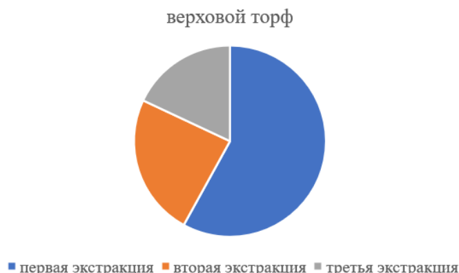
Рисунок 1 – Выход ФПК из верхового торфа при последовательной трехкратной обработке
