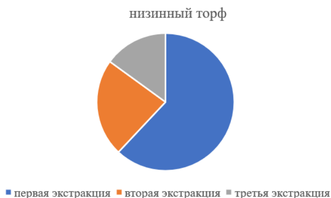
Рисунок 2 – Выход ФПК из низинного торфа при последовательной трехкратной обработке
