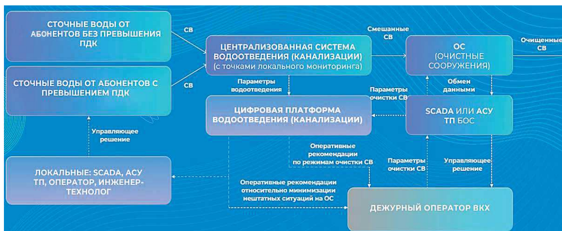
Рис. 2. Структура общей системы управления по каналу «Отведение и очистка водных ресурсов» с включением промышленных предприятий в единую цифровую АСУ ТП платформенного типа
