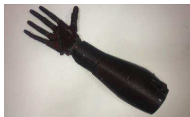
Рисунок 7 – Распечатанная на 3D принтере роботизированная рука
