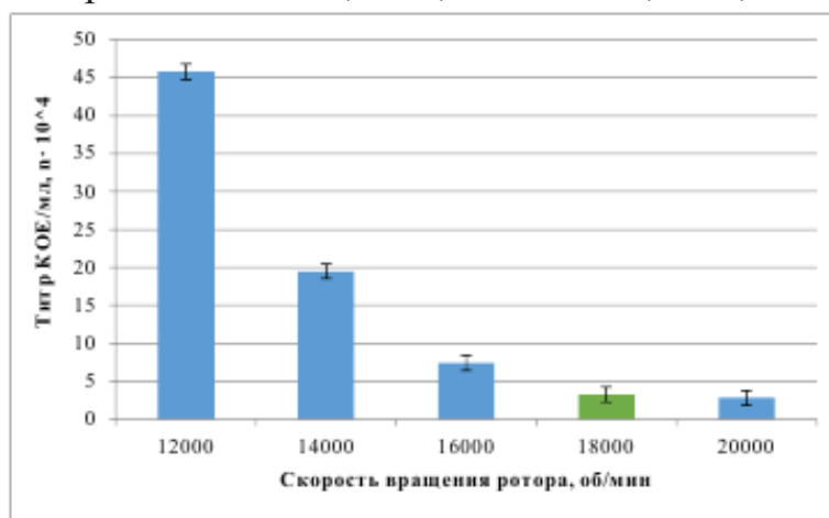
Рисунок 1 – Зависимость остаточного титра бактерий в супернатанте от скорости вращения ротора центрифуги (при постоянной подаче)
