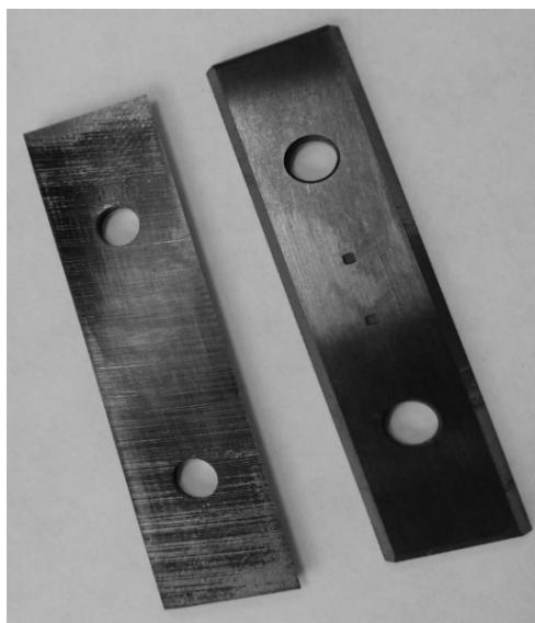
Рис. 1. Дереворежущие ножи концевой фрезы с алмазоподобным DLC-покрытием 1
