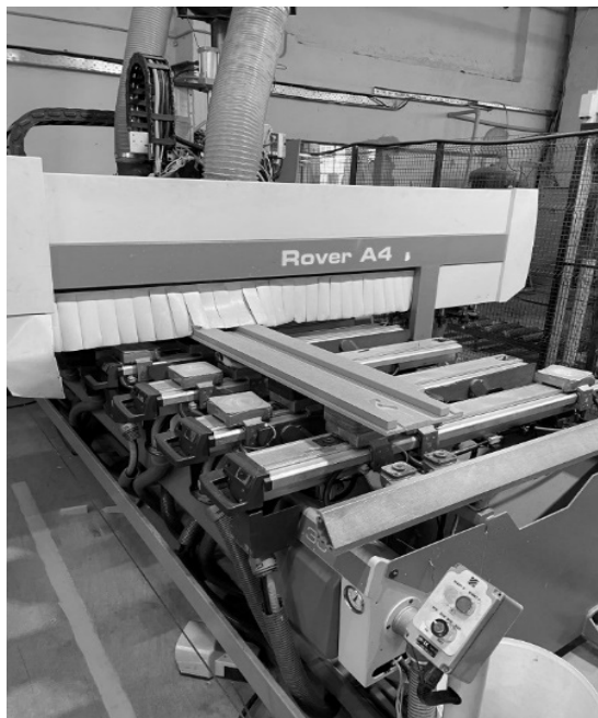
Рис. 3. Машина Biesse Rover A4.30 с числовым программным управлением
