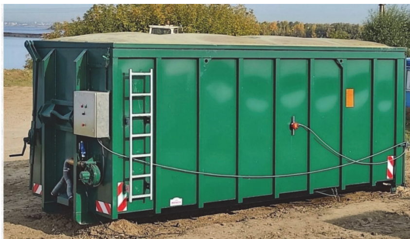
Рис. 6. Мобильный биореактор для производства компоста
