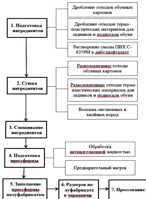
**Рисунок 1 – Лабораторная технология получения проб волокнистонаполненных композиционных материалов**
