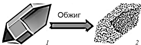
Рисунок 1 – Схема темплатного синтеза: 1 – исходный MOF; 2 – пористый оксид [1].
