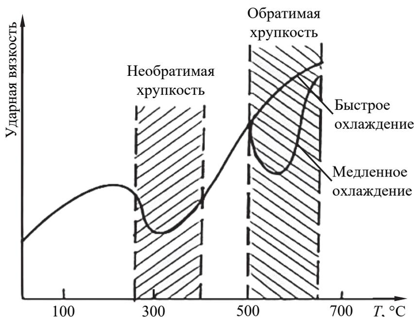
Рис. 6.3. Изменение ударной вязкости легированной стали в зависимости от температуры отпуска и последующей скорости охлаждения
