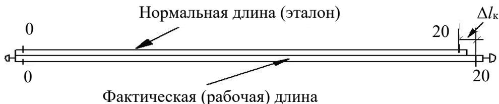
Рис. 1.16. Компарирование землемерных лент (рулеток)
