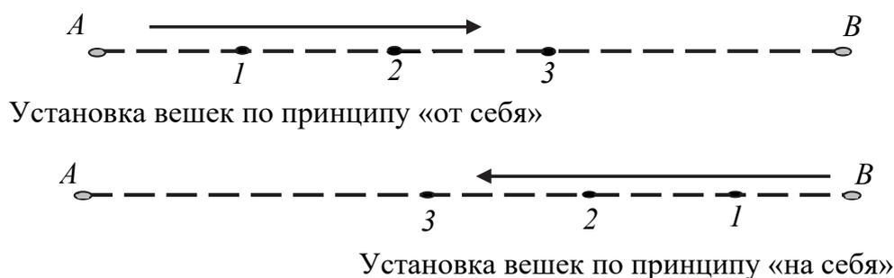
Рис. 1.17. Установка вешек при разных схемах провешивания линии
