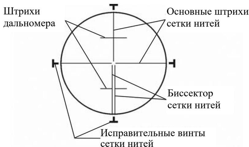
Рис. 1.2. Сетка нитей зрительной трубы теодолитов Т30 (2Т30)
