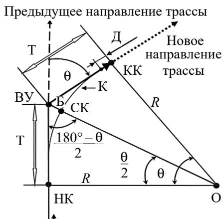
Рис. 9.4. Разбивка главных точек круговой кривой (пример)
