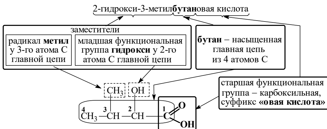
Рис. 3. Пример составления названия соединения по систематической номенклатуре IUPAC
