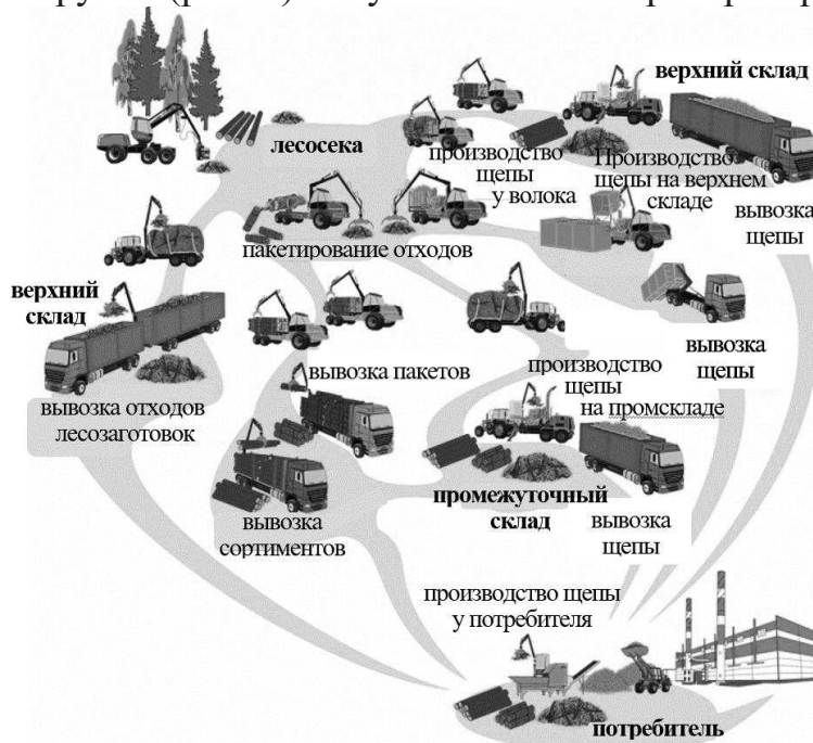
Рисунок 1 – Комплексная технология заготовки деловой древесины и топливной щепы
