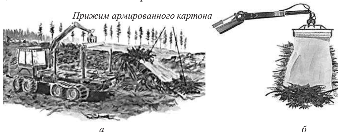
1 – укладка армированного картона поверх вала древесной кроны; 2 – ролик с армированным картоном
