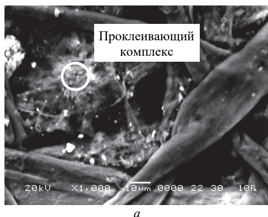
Рис. 11. Структура поверхности образца бумаги (элементарного слоя картона), изготовленного по способу 4 из бумажной массы состава 10 (а), и элементный состав проклеивающего комплекса (б), полученных методом электронной микроскопии (увеличение \times 1000 )
