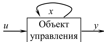
Рисунок 1 – Переменные объекта управления
