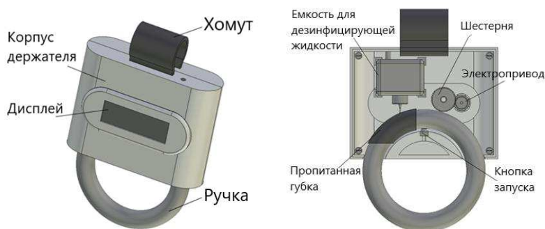
Рисунок 1 – Конструкция подвешного держателя
