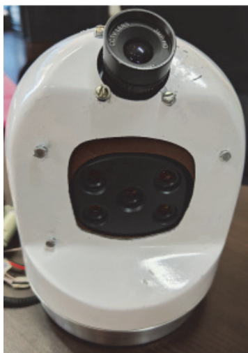
Рис. 2. Целевая нагрузка мультиспектральной камерой для БПЛА типа «Бусел»
