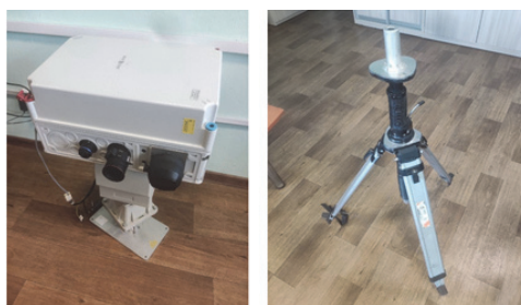
Рис.1. Установка с гиперспектральной камерой для наземной штативной съемки
