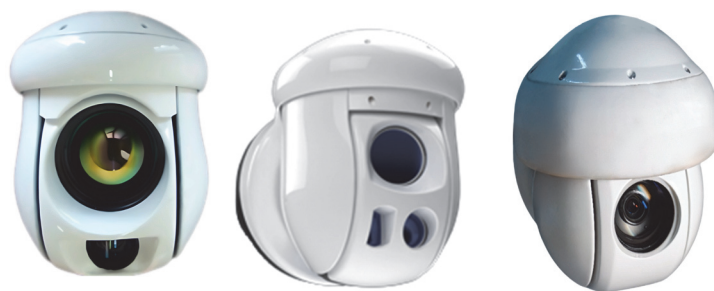
Рис. 3. Гиростабилизированные оптико-электронные системы для проведения работ, связанных с исследованием леса и растительного покрова, разработана и применяется мультиспектральная ОЭС.
