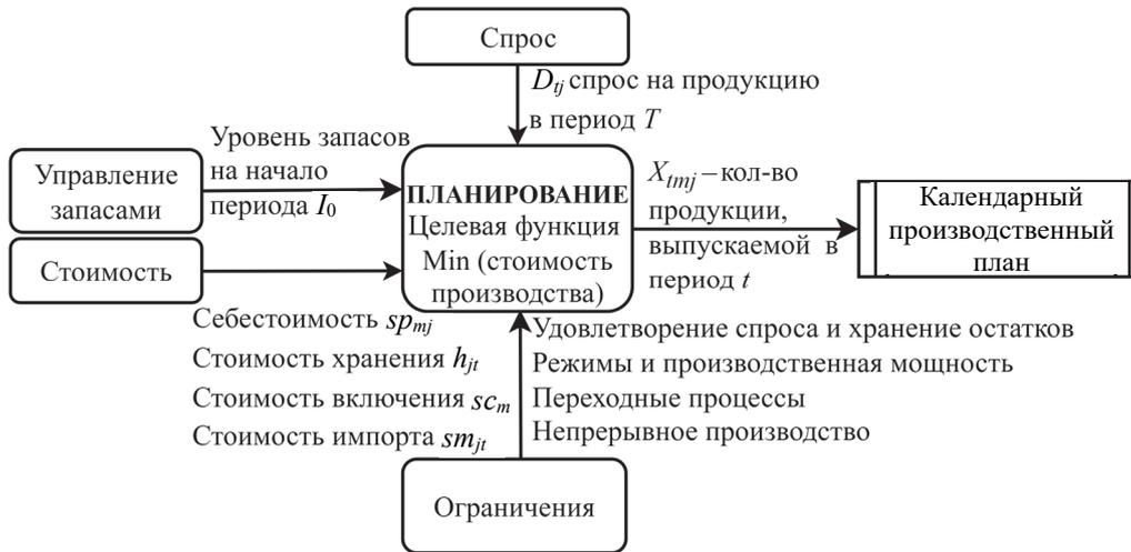
Рис. 2. Модель оптимизационного планирования производства продуктов разделения воздуха
