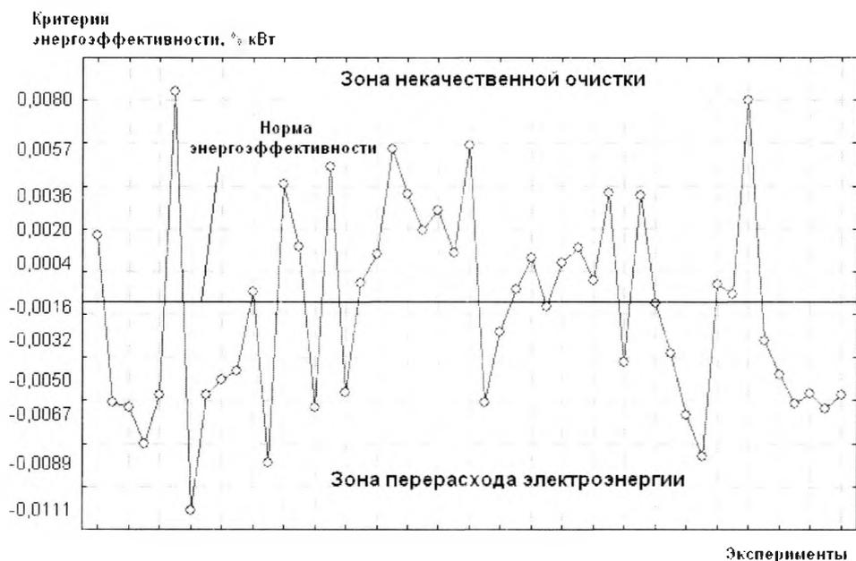
Рисунок 7 – Экспериментально полученные в ВМЭВО значения ЕЕЕ промышленной водоочистки
