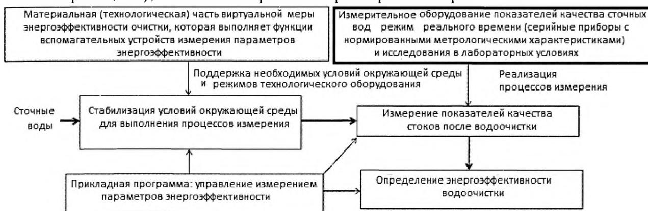
Рисунок 2 – Модель измерения эколого-энергетических параметров водоочистки на основе использования ВМЭВО
