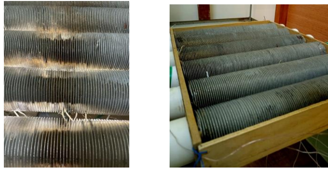
Рисунок 2 – Фотографии экспериментального однорядного пучка с внешним межреберным загрязнением труб
