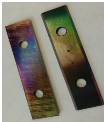
Рисунок 1 – Дереворежущие ножи концевой фрезы с алмазоподобным DLC-покрытием
