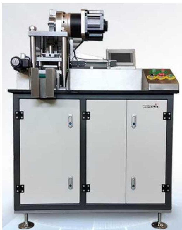
Рисунок 1 – Автоматический вырубщик пластиковых карт WL-HS-2A PLC
