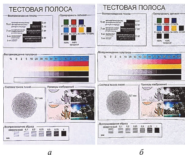
Рис. 4. Образцы тестовой полосы струйной печати на бумаге: а – «Навигатор»; б – «Снегурочка»
