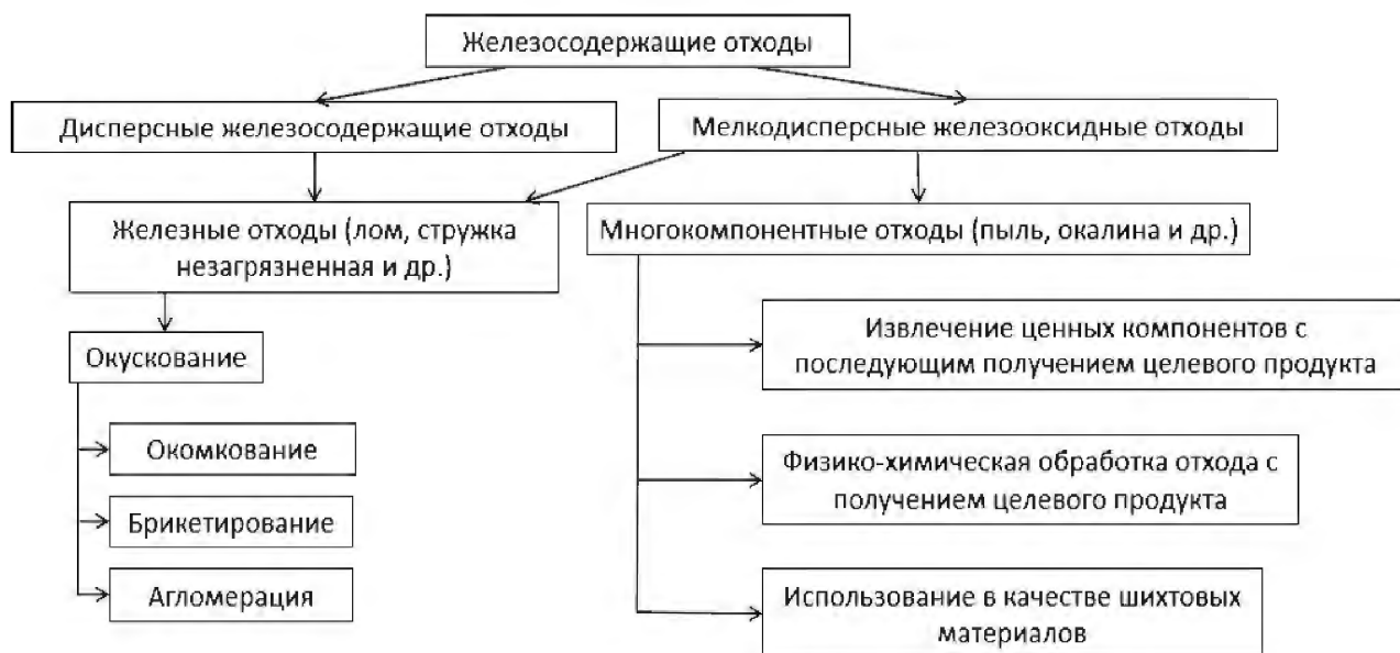
Рис. 1. Способы переработки железосодержащего сырья
