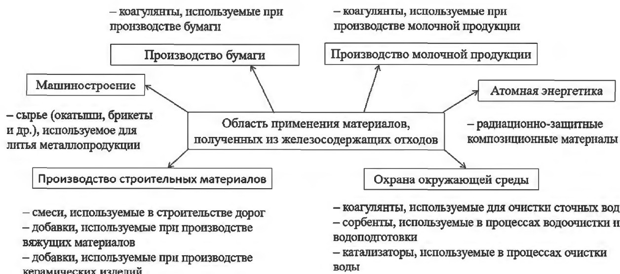
Рис. 2. Область применения материалов, полученных из железосодержащих отходов производства
