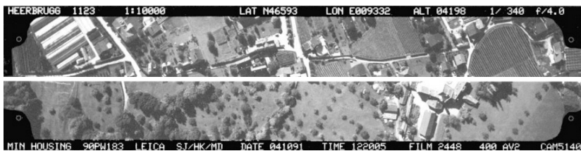
Рис. 2.8. Дополнительная информация на полях аэрофотоснимка камеры RC-30
