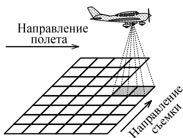
Рис. 2.22. Схема формирования изображения камерой АЗ
