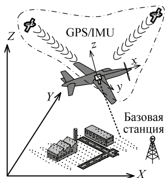
Рис. 2.27. Общая схема лазерной локации
