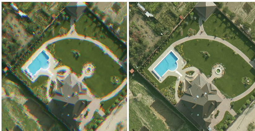
Рис. 1. Исходное ( а ) и ректифицированное ( б ) изображения, полученные сканирующей камерой 3-DAS
