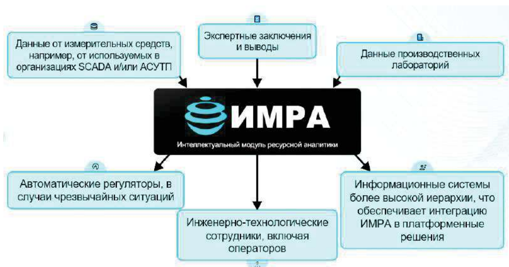
Рис. 3. Схема информационных потоков интеллектуального модуля ресурсной аналитики
