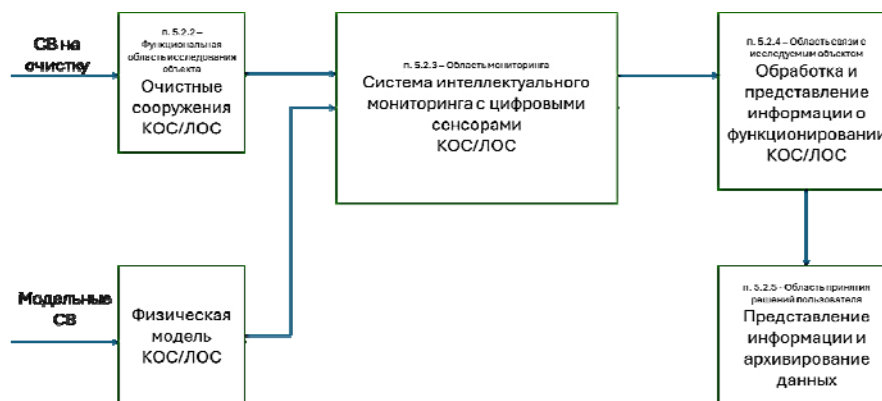
Рис. 7. Концептуальная модель цифрового двойника очистных сооружений на этапе функционирования в соответствии с общими принципами ISO 23247-2 : 2021: КОС – комплексные очистные сооружения
