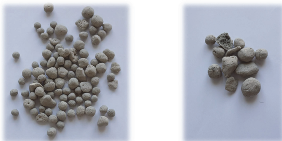
1-rasmda olingan granulalangan penosteklo namunasi ko‘rsatilgan
