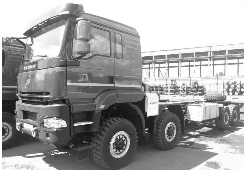
Рис. 3. Шасси МАЗМАН 737459 с колесной формулой 8х8 со всеми ведущими мостами с системой ЦНШ
