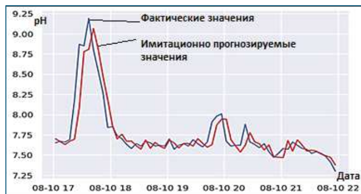
Рис. 4. Графическая интерпретация сравнения результатов имитационного моделирования (прогнозирования) pH городских сточных вод на входе очистных сооружений с фактически зафиксированными значениями
