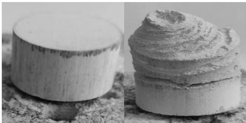
Рисунок 2 - Горение образца системы \text{ZnSO}_4\text{-Al}_2(\text{SO}_4)_3\text{-Na}_2\text{O}_2
