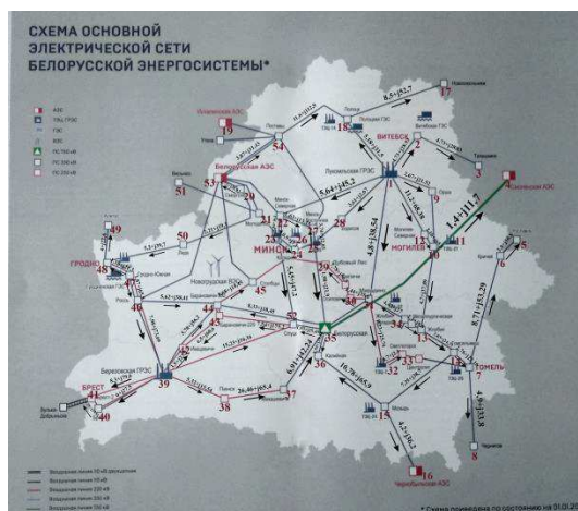
Рис. 2 - Схема основной электрической сети Белорусской энергосистемы
