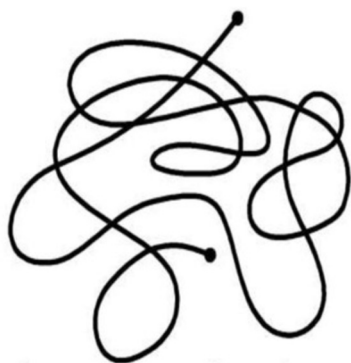
Рис. 6. Статистический клубок макромолекулы линейного полимера
