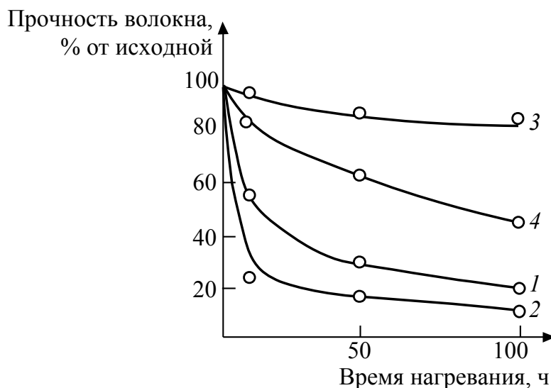
Рис. 68. Изменение прочности полиамидного волокна (капрон) в зависимости от времени нагрева при 150 (1, 3) и 180°C (2, 4) (стабилизатор N, N'-ди-β-нафтил-пара-фенилендиамин введен в процессе полимеризации): 1, 2 – без стабилизатора; 3, 4 – со стабилизатором
