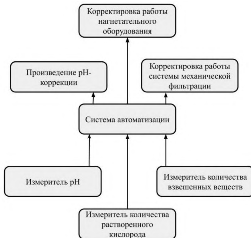
Рисунок 3 – Предлагаемая схема управляющих воздействий при автоматизации биофильтра в УЗВ
