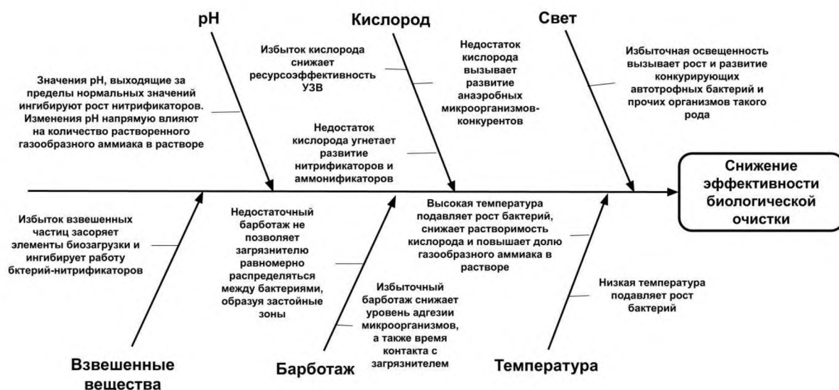
Рисунок 1 – Причинно-следственная диаграмма Исикавы описывающая негативное влияние многоуровневой иерархии факторов на процесс биофильтрации в УЗВ
