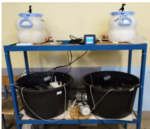
Рисунок 2 – Лабораторная модель системы биологической фильтрации
