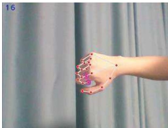
Рисунок 1 – Отображение скелета конечности при использовании MediaPipe
