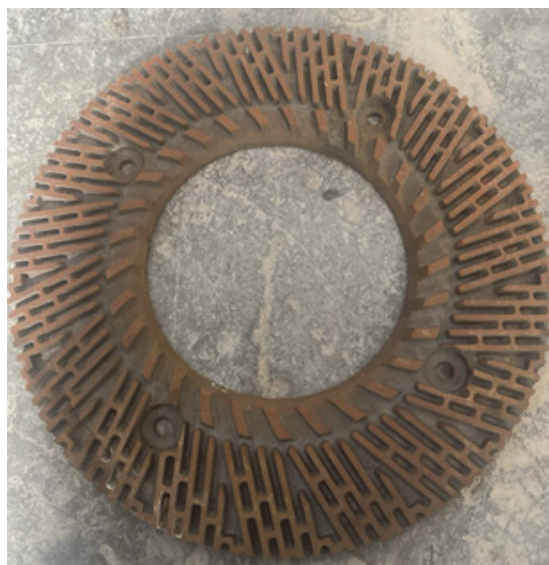
Рис. 2. Общий вид гарнитуры с прямолинейными ножами и равномерным распределением
