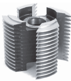
Рис. 6.13. Вид зубчатого шипового соединения ( а ), режущий инструмент (фреза) ( б ) и схема формирования шипа ( в )
